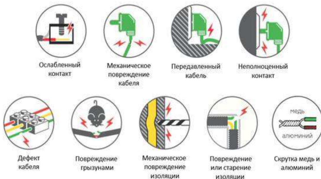
Рисунок 6. Возможные причины искрения в электропроводке
